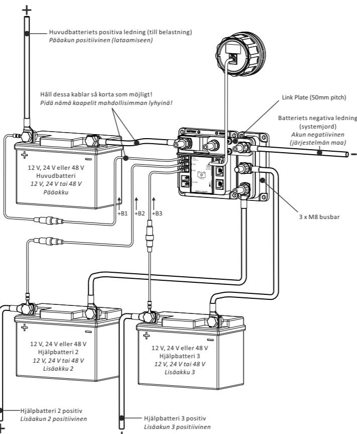
**Anslut alltid den negativa batterikabeln sist när installationen är slutförd.**
