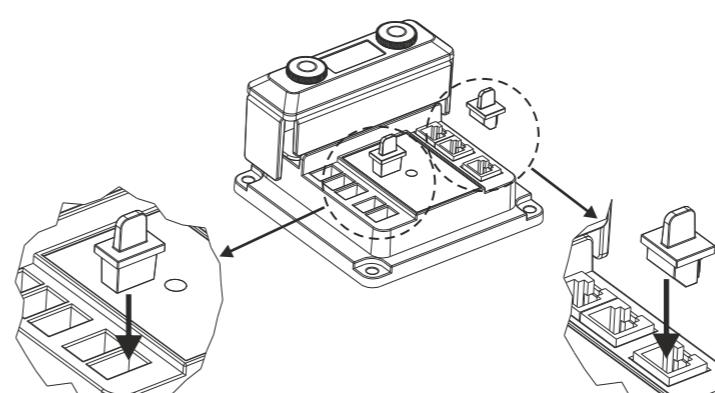
Consulte la ilustración anterior para cubrir los puertos no utilizados del módulo de derivación activa. En el embalaje se incluye una selección de cubiertas de goma. Consulte a ilustração acima para ver como cobrir as portas não utilizadas do módulo de derivação ativa. Está incluída na embalagem uma seleção de peças de cobertura de borracha.
