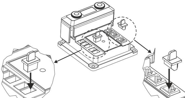
Se bilden ovan om hur man täcker över portar som inte används i den aktiva shuntmodulen. Ett urval av gummiskyddsdelar medföljer i förpackningen.
