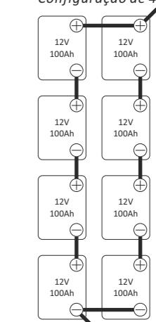
**Conecte siempre el cable negativo de la batería en último lugar cuando haya terminado la instalación.
