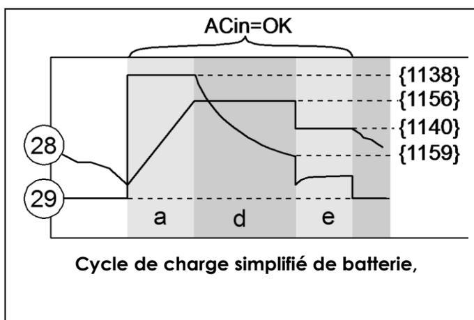
durée est fixée par le paramètre {1157}. L'intervalle minimal entre deux cycles d'absorption est limité par le paramètre {1161}
