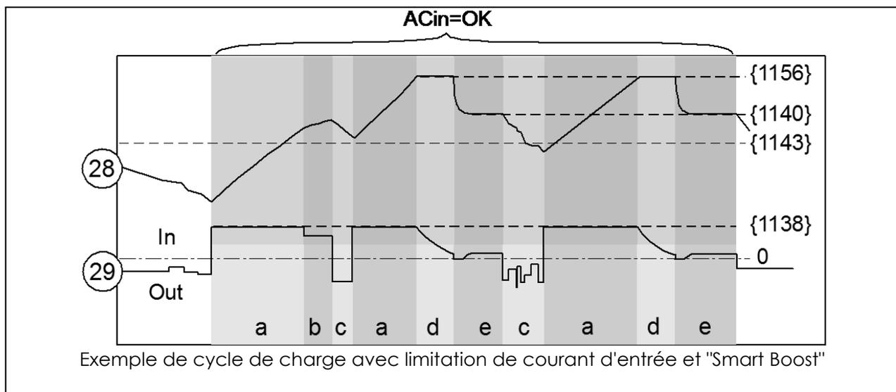
Si le capteur de température BTS-01 est utilisé, les seuils de réglage de tension de la batterie sont corrigés en temps réel en fonction de la température de la batterie. La valeur de cette correction est fixée par le paramètre {1139} dans le tableau de valeur des paramètres p. 42.
