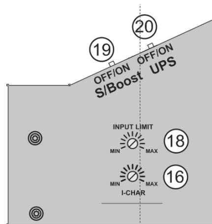
Les réglages faits par ces boutons et potentiomètres peuvent être interdits par le paramètre {1551} via la télécommande RCC-02/03. Ces grandeurs seront alors définies par les paramètres réglés sur la télécommande. Si le paramètre {1551} est réglé sur « oui », les boutons 16, 18, 19 et 20 resteront inactifs même si la télécommande et le module de communication sont retirés après paramétrage.
