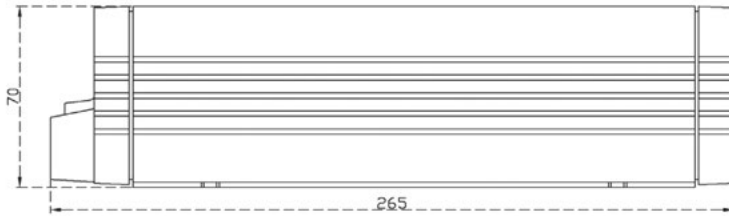
Afbeelding 7 WSC-1230 / WSC-2415 lader zijaanzicht (mm)
