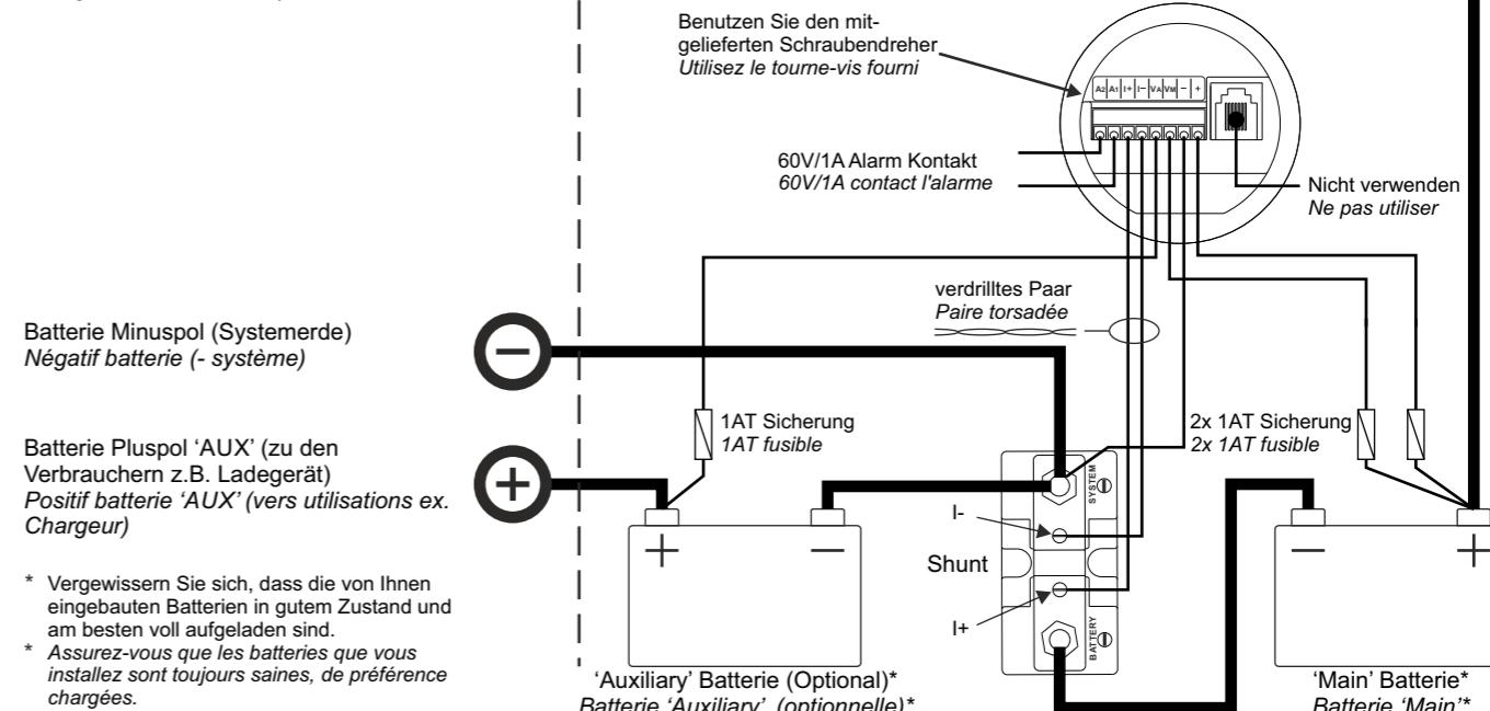
Der Shunt muß immer in die negative Hauptversorgungsleitung angebracht werden. Das Anbringen des Shunts in die positive Leitung kann den Batterie Monitor beschädigen!
